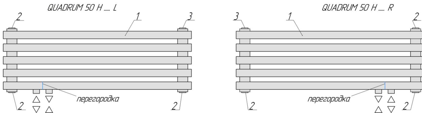
Рис. 4 1. Радиатор. 2. Пробка глухая. 3. Кран-воздухоотводчик.
